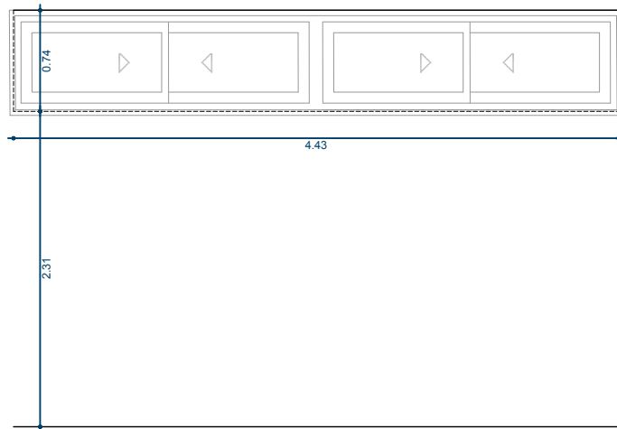
PS.04 Finestres corredisses. [443 x h74cm] Finestra d'alumini anoditzat 4 fulles corredisses [2 fulles per fusteria.] Trencament de pont tèrmic, col·locada sobre bastiment de base. [1ud.]
