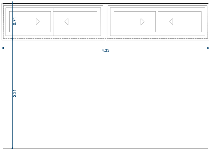
PS.02 Finestres corredisses. [433 x h74cm] Finestra d'alumini anoditzat 4 fulles corredisses [2 fulles per fusteria.] Trencament de pont tèrmic, col·locada sobre bastiment de base. [1ud.]
